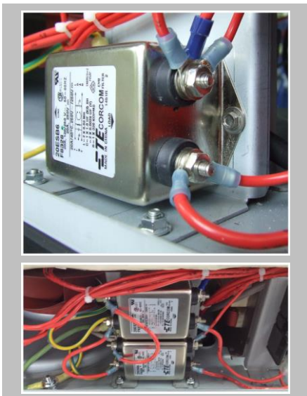
Felül: egy zavarászűrő egység (1000 W e2s változat) Alul: két zavarászűrő egység (2000 W e2s változat)
